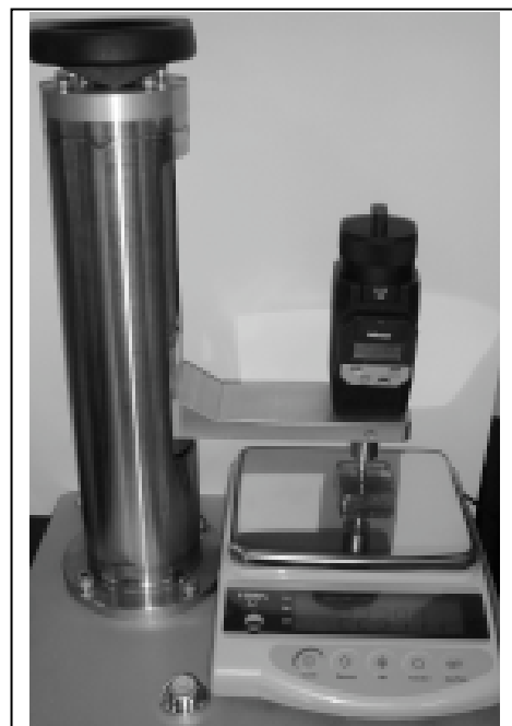
図 2 簡易弾性率計の写真
